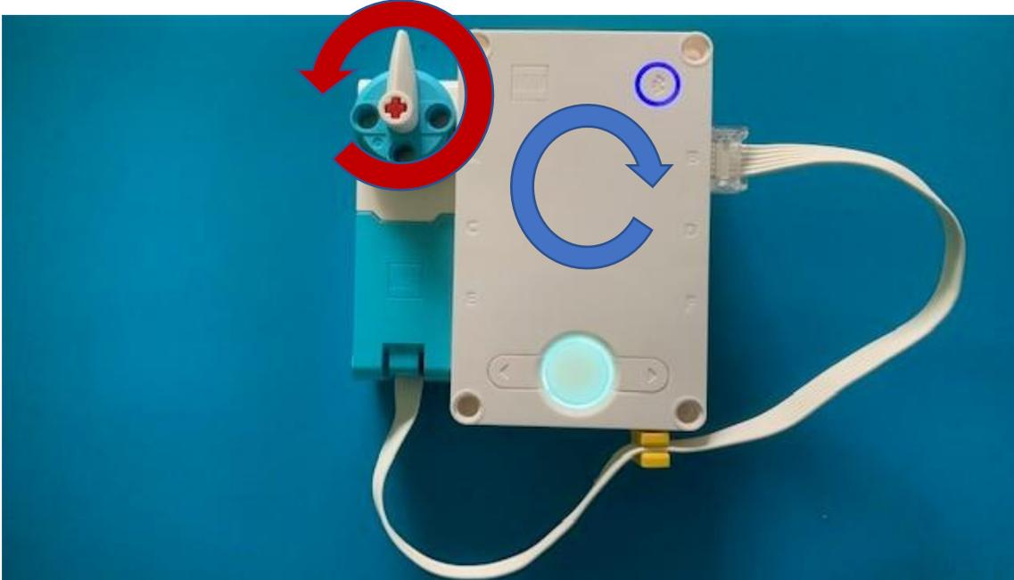
Según vayamos girando el Hub el motor tiene que rotar en grados inversos para que siempre apunte a la misma dirección.
