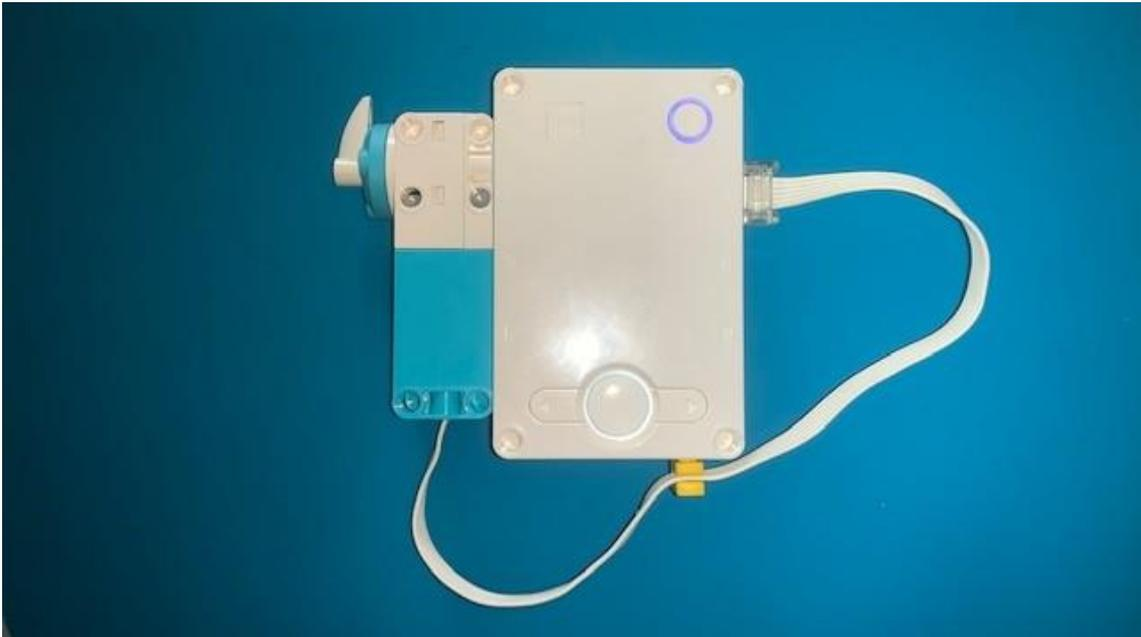
Según vayamos inclinado el Hub por la parte delantera o trasera nuestro motor se tiene que mover para señalar en la misma dirección.
